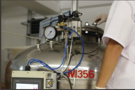
Basınç Test Tankı (EN 60529 IP Testi)
