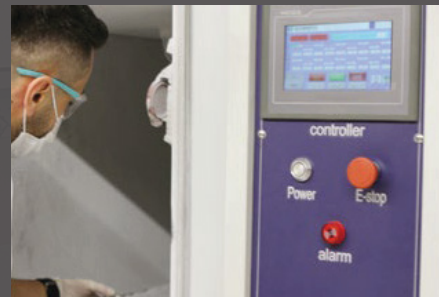
Kum Ve Toz Testi (EN 60529 IP TESTİ)
