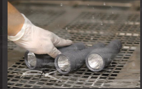
Su Püskürtme Testi (EN 60529 IP TESTİ)
